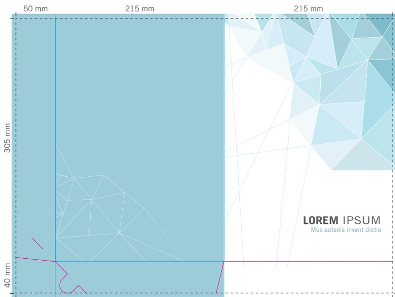
Si l'intérieur de la chemise est imprimé, pensez à tourner la forme de découpe pour réaliser la mise en page, comme sur l'exemple ci-dessous où les rabats sont imprimés :
